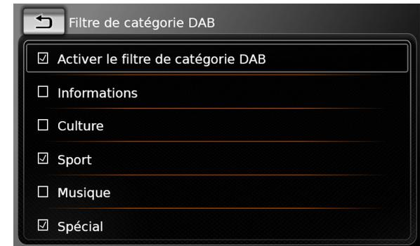
Pour sélectionner les types de programme, ▶ appuyez sur le type de programme désiré. Un type de programme est sélectionné quand la case est cochée.
